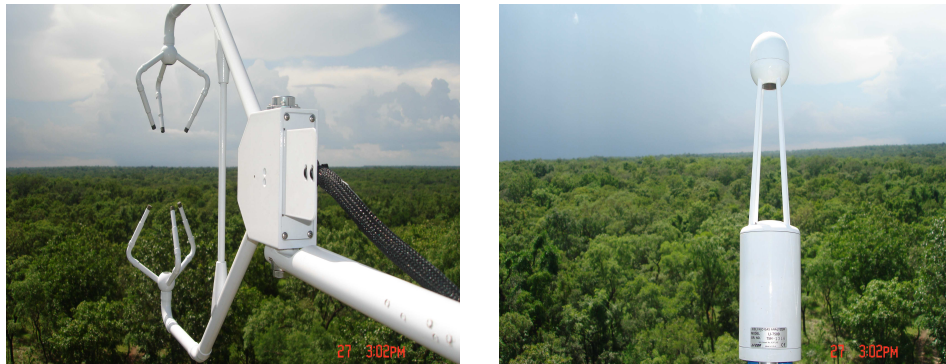
FIG. 1.2 – L'anémomètre sonique (gauche) et le Licor (droite) effectuant des mesures sur la forêt claire de Bellefougou.
