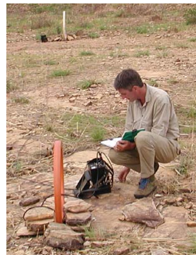
Photo 16 : Vérification de la dérive de L'EM 34 sur une base.
