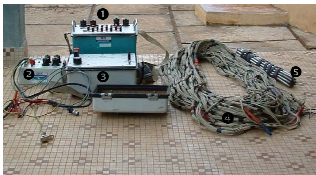
Photo 10 : Matériel annexe du Syscal. (1) multinodes, (2) convertisseur, (3) RCM, (4) câbles de connections, (5) électrodes.
