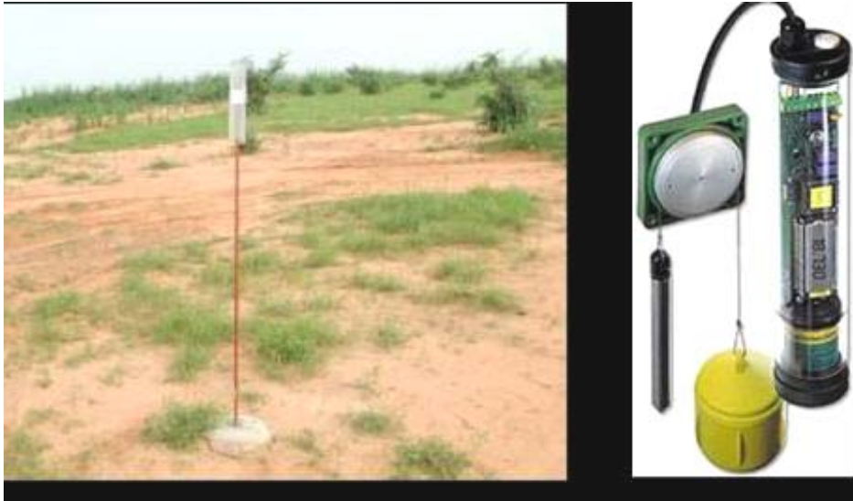
Photos 3 & 4: Pluviomètre à lecture directe (Photo 3) et Limnimètre enregistreur à flotteur (Photo 4) type Thalimed (OTT) (Photos RONGICONI L. Wankama septembre 2004)
