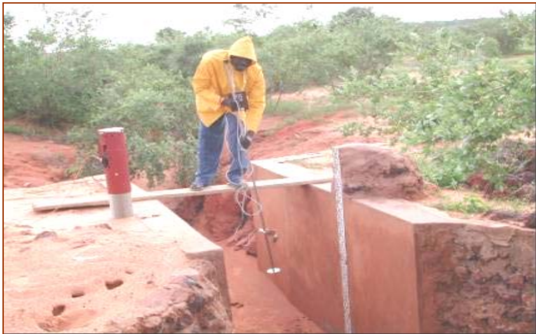
Photo 3: Dispositif de jaugeage à la station aval zone d'épandage de Wankama (Photos RONGICONI LAURA. Wankama septembre 2004)
