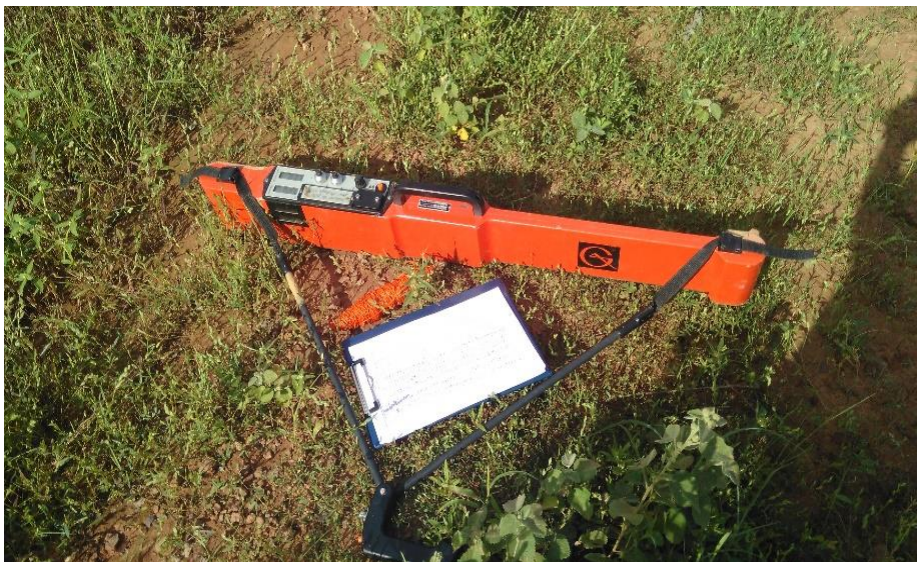
Figure 3.8. EM38, fiches de terrain et fil utilisés pour les mesures de la conductivité électrique par induction électromagnétique.
