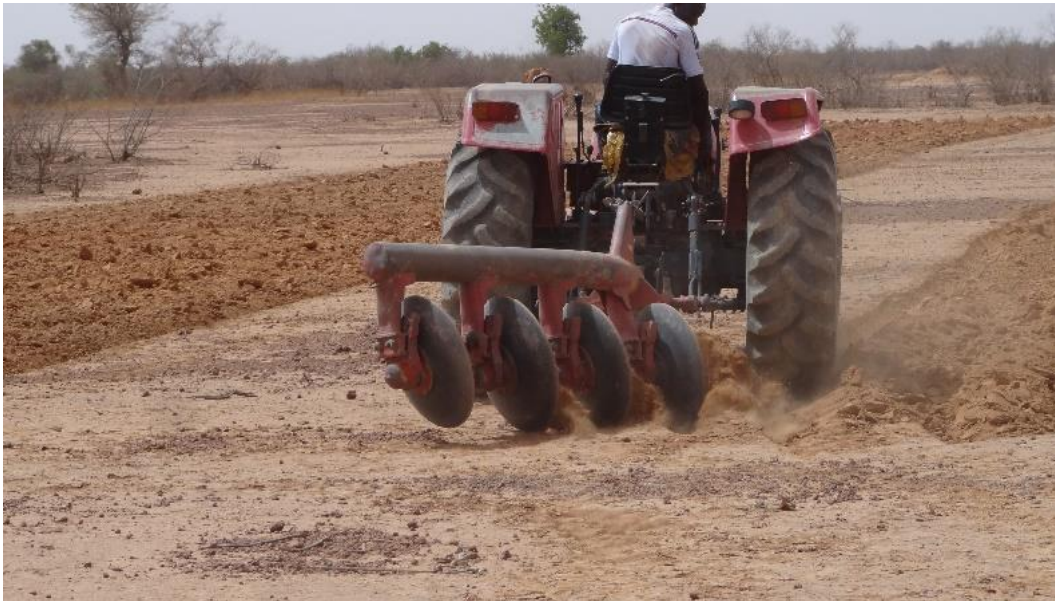
Figure 2.22. Pratique du sous-solage avec un tracteur ordinaire sur le sol nu du plateau.
