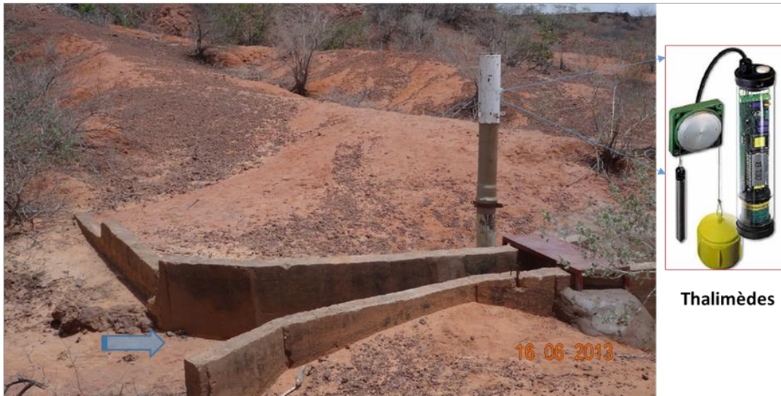
Figure 3.19. Exemple d'une station de mesures de l'écoulement (BV TK amont Sud). La flèche montre le sens de l'écoulement.
