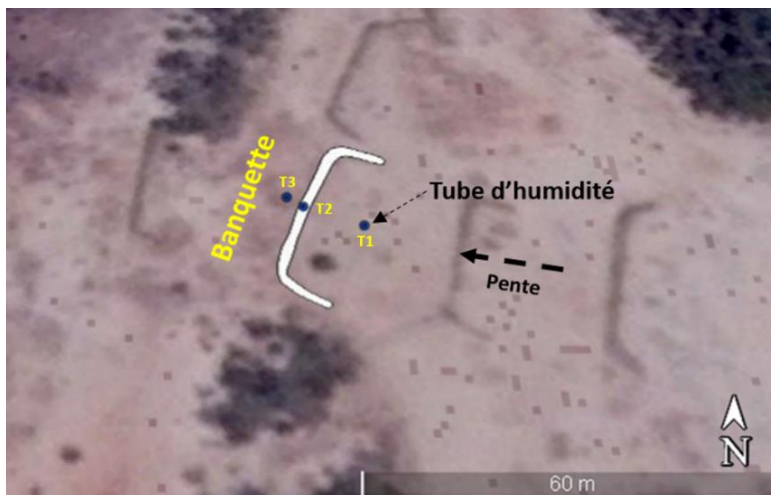
Figure 3.4. Emplacement des tubes de suivi de l'humidité du sol pour une banquette. La numérotation des tubes d'humidité est identique pour les trois banquettes suivies.
