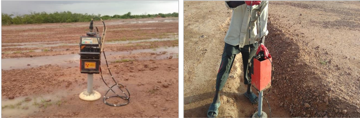
Figure 3.5. Sonde à neutrons et réflecteur en cours d'utilisation sur une parcelle de sous-solage (à gauche) et dans une banquette (à droite).
