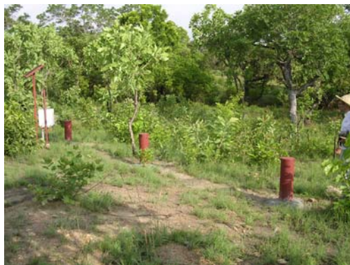
Photo III.2 : Site du bas de versant de Nalohou : 3 piézomètres (à 2, 10 et 20 m de profondeur) et une guérite blanche protégeant la centrale d'acquisition des données d'humidité)
