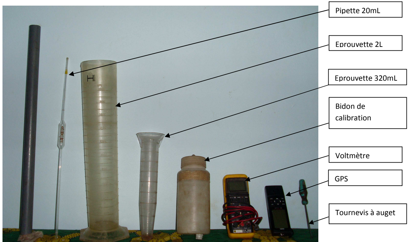
Figure 4 : Matériel nécessaire pour le relevé des stations pluviographiques
