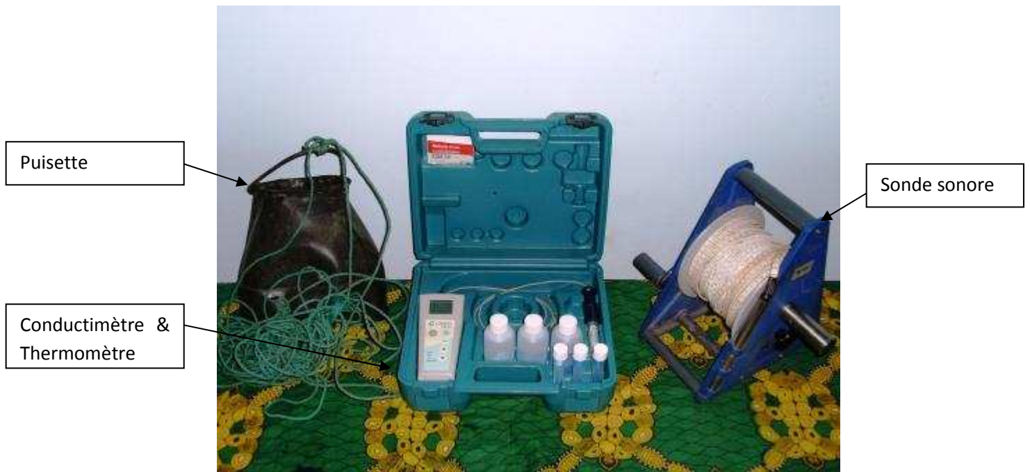
Figure 6 : Puisette pour la mesure de conductivité et température & Sonde sonore pour la mesure de hauteur d'eau des eaux souterraines (puits) et de surface (rivières)
