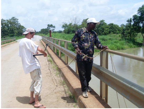
Figure 8 : Jaugeage depuis un pont
